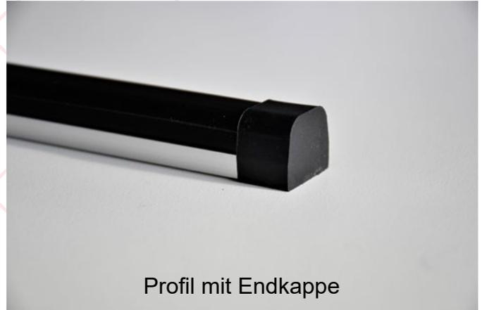
Die TS8 ist eine flache Schaltleiste. Durch ihren kurzen Betätigungsweg eignet sie sich besonders zur Quetschkantenabsicherung mit geringem Nachlaufweg. Sie wird mit der zugehörigen flachen Aluminiumschiene montiert. Jeder Schaltleiste liegen Endkappen zum Aufstecken bei. Diese Endkappen umschließen sowohl das Profil als auch die Schiene.
