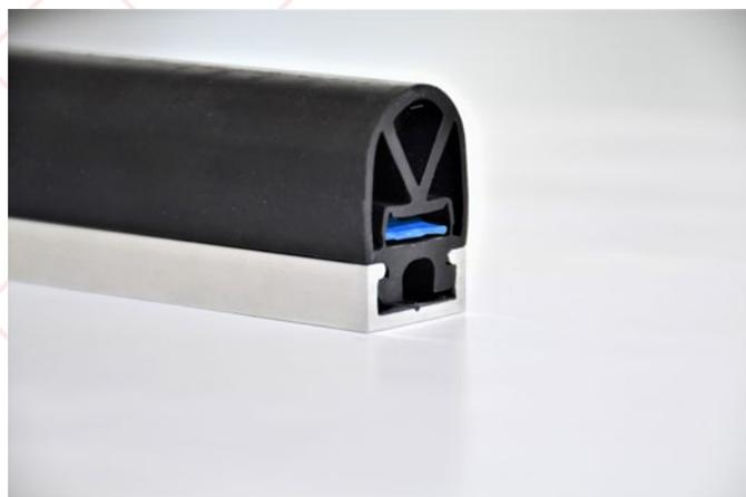
Die TS26 ist eine sehr vielseitige Schaltleiste für den Einsatz bei einer Fülle von Sicherheitsapplikationen. Die in rot und schwarz erhältliche Schaltleiste wird in die zugehörige Montageschiene eingeschnappt.
