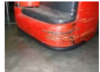
Das Beispiel zeigt eine typische Anwendung mit Rundungen. TS19 aufgeklebt an einem Elektro-Hubwagen.
