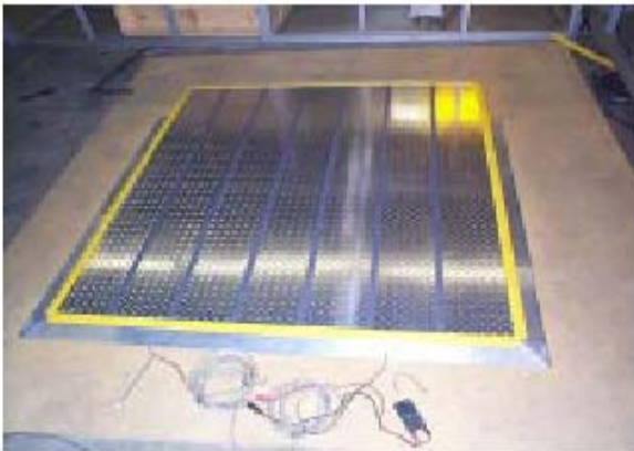
Schritt 7: Die fertig montierte Schaltmatte Typ DPM.
